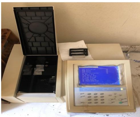
**Figure 3.6 :** UV spectrophotometer (UV mini 1240 SHIMADZU).
