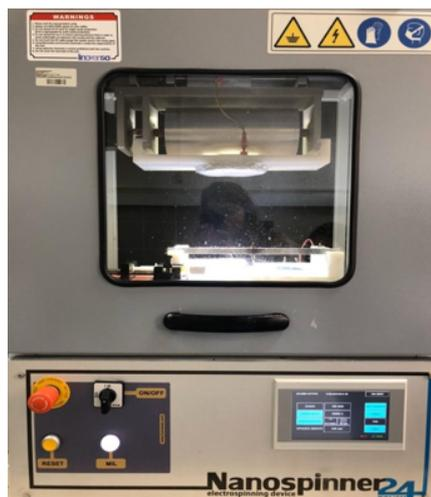
**Figure 3.4 :** Electrospinning Instrument (Inovenso, Nanospinner 24).
